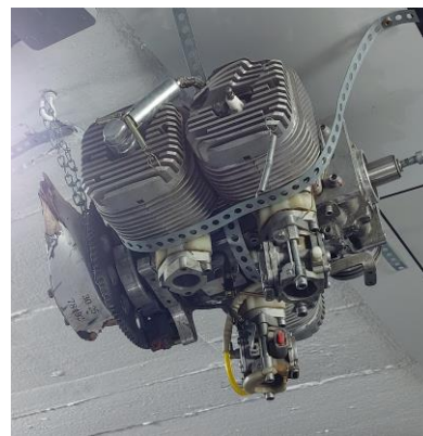
Vier- Zylinder-Motor einer Shahed und Sprengkopf – Ausstellung zur Ukraine Berlin 2024
